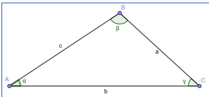
El teorema del Seno establece la relación que existe entre la longitud de uno de los lados del triángulo y el seno del ángulo opuesto al lado. Esta relación se mantiene siempre constante para los tres lados.
